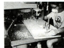
バーニング・ウォーターのボディをルーティングしているところ。
