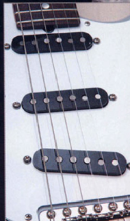
▲オーソドックスなパッシブ・タイプのオリジナル・シングルコイル・ピックアップを採用。これは繊細だがコシのある、絶品ハーフ・トーンの要因となっているようだ。
